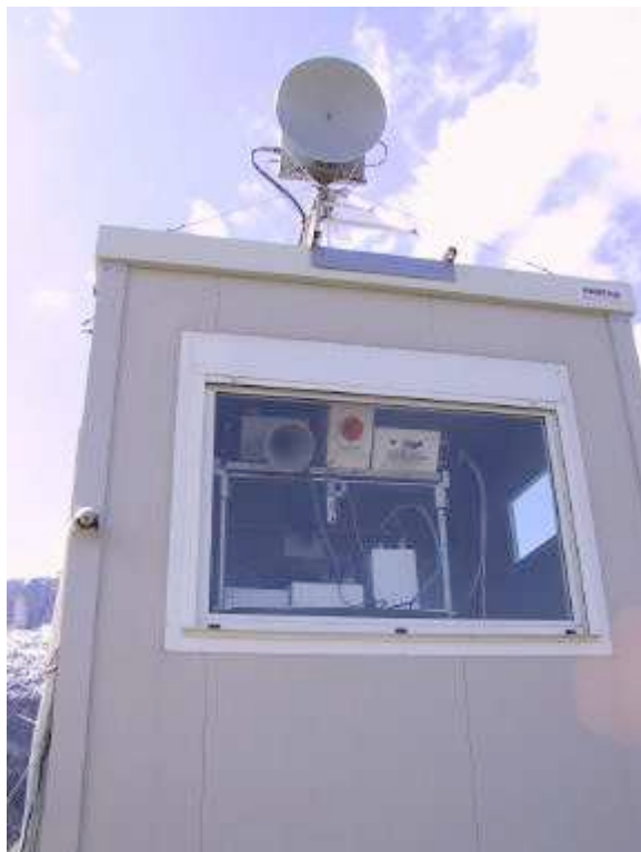
Figura 7.3.2 ? Il box contenente i radiometri (Foto: cortesia di R. Ranzi)
