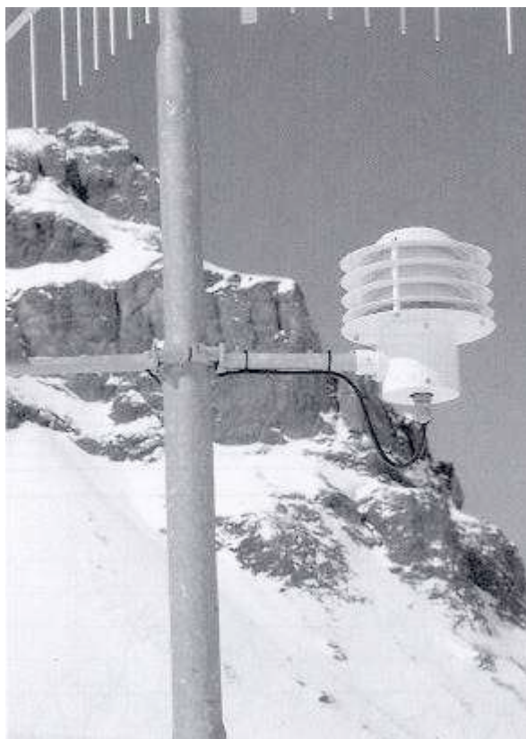
Figura 7.3.2.2 ? Termometro dell'aria (Foto: Annuale Niveometeorologico delle montagne venete, 2001 (ARPAV))
